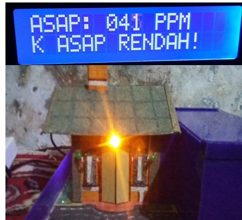
Gambar 20. Tampilan Pada LCD Kadar Asap Rendah
