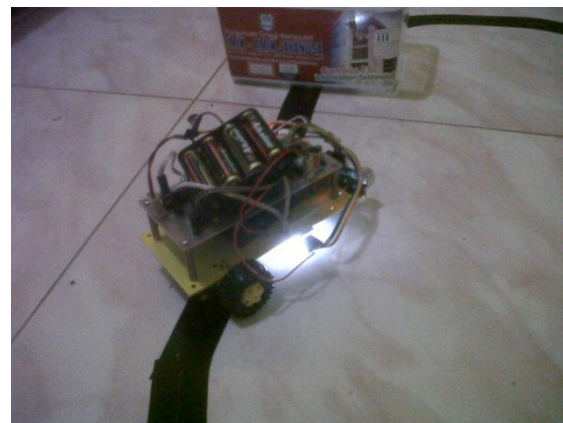
Gambar 20. Robot Mendeteksi Benda yang ada pada jalurnya
