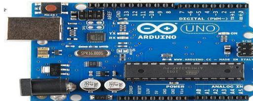
Gambar 5. Mikrokontroler Arduino Uno
