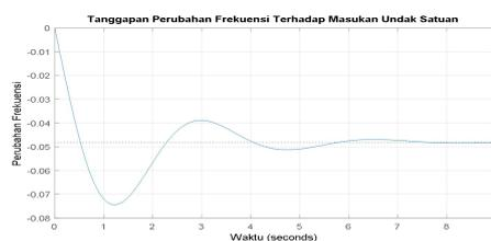
**Gambar 7.** Tanggapan Peralihan Deviasi Frekuensi Untuk Tipe *Non – Reheat*
